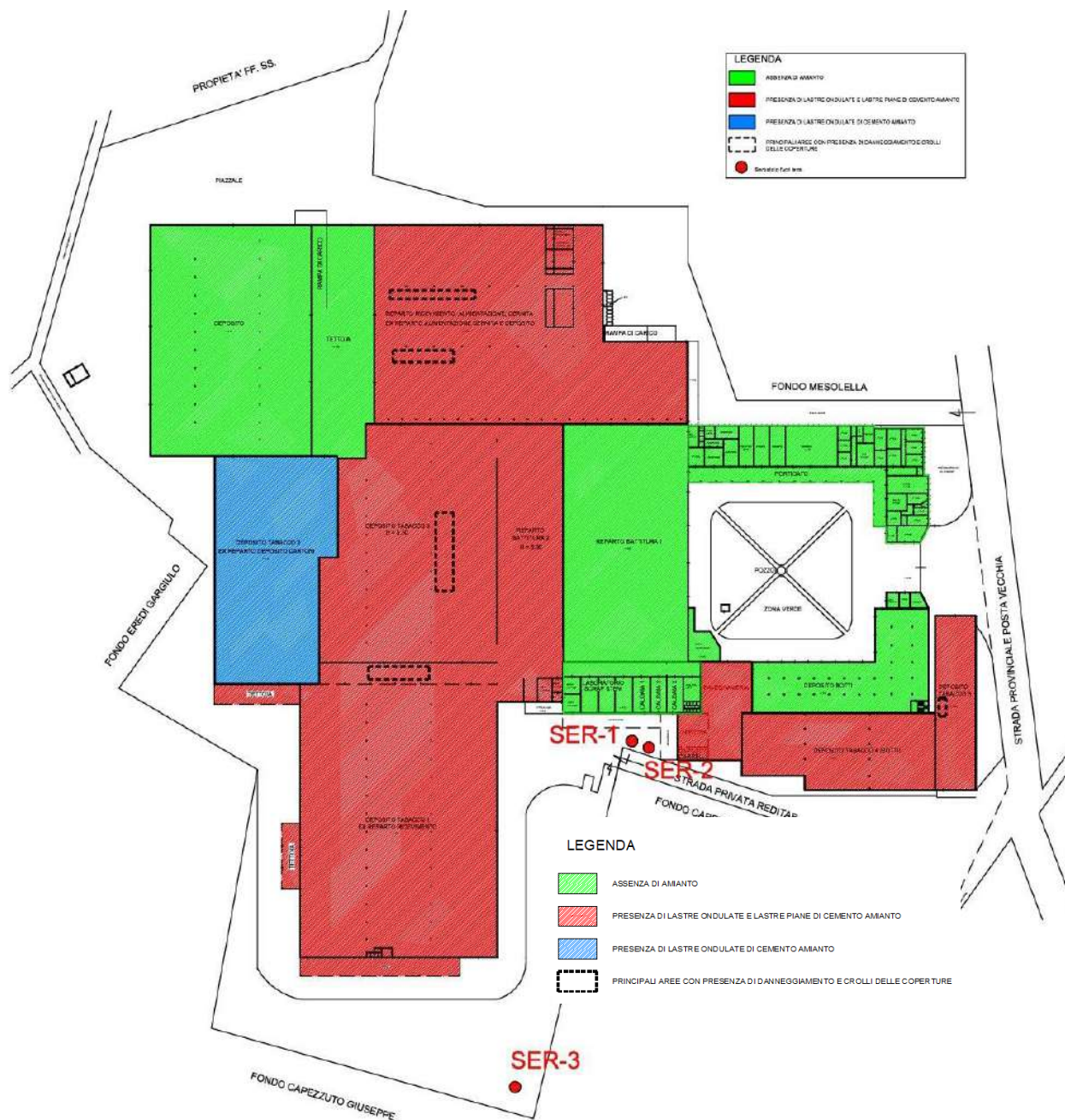
Figura 8: Planimetria ubicazione coperture in cemento-amianto e principali punti di crollo e danneggiamento
